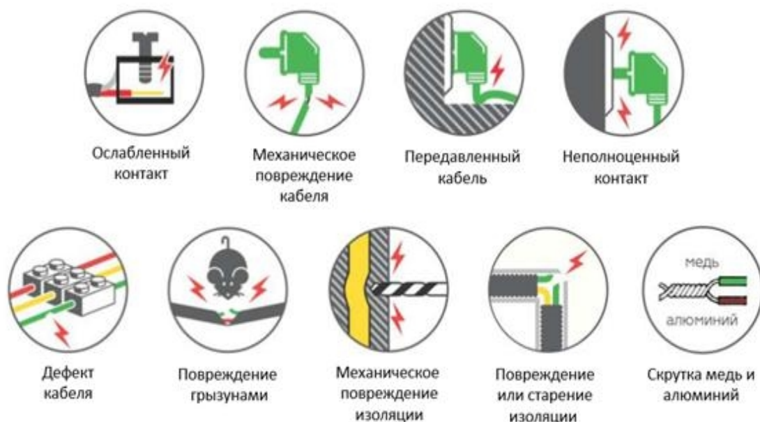
Рисунок 6. Возможные причины искрения в электропроводке
