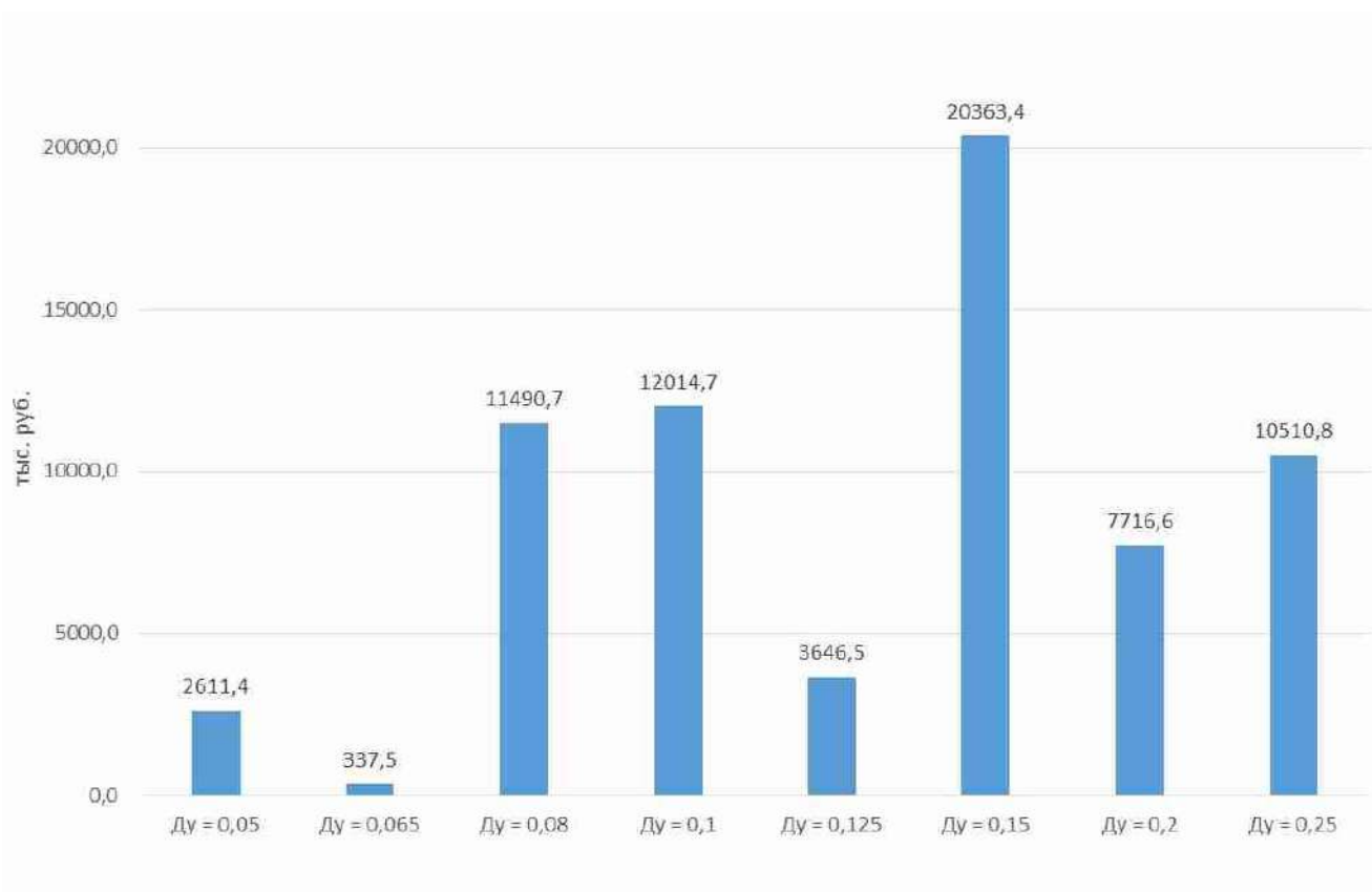
Рисунок 6.6.4.2 - Суммарные капитальные вложения в строительство новых квартальных тепловых сетей для 2-го варианта развития энергоисточников муниципального образования «Город Таганрог» с разбивкой по зонам
