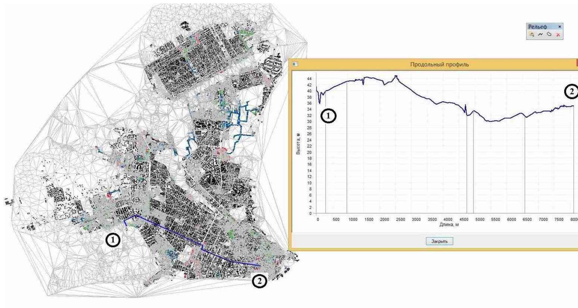
Рисунок 2.1.1а – Продольный профиль трассы от места расположения ПГУ ТЭЦ3 (1) до потребителя (2)
