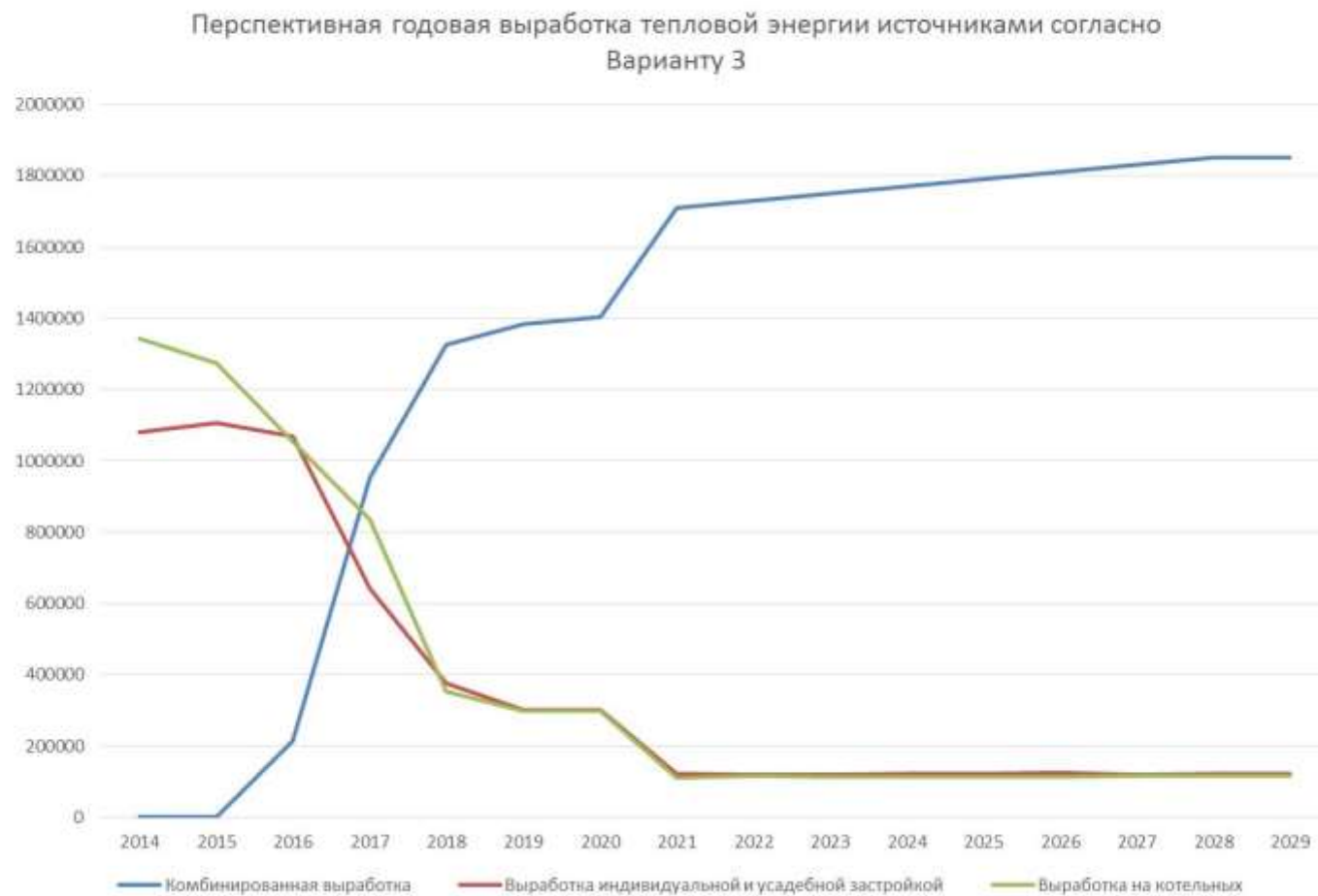
Рисунок 3.4.1 – Перспективная годовая выработка тепловой энергии источниками согласно Варианту 3 (Гкал/год)
