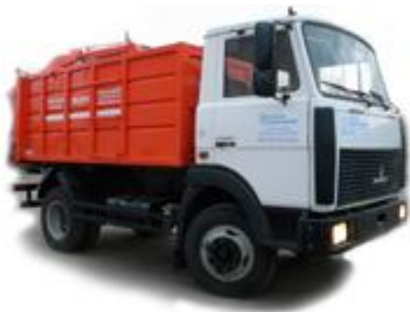
Рисунок 8 - Мусоровоз с ручной задней загрузкой MAZ-457043-342-010 МКЗ-3900
