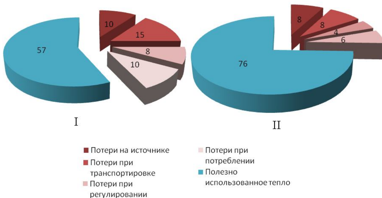
Рис. 10. Структура потерь тепловой энергии в системах с централизованным теплоснабжением до (I) и после (II) технологической модернизации
