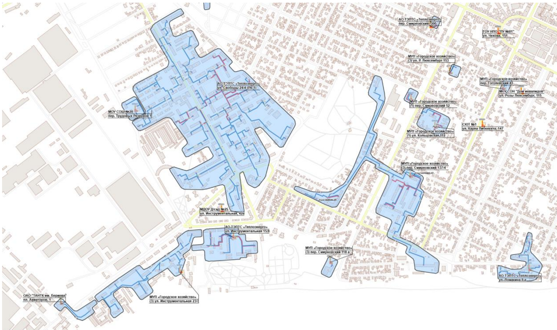
Рисунок 7 - Зоны действия источников теплоснабжения
